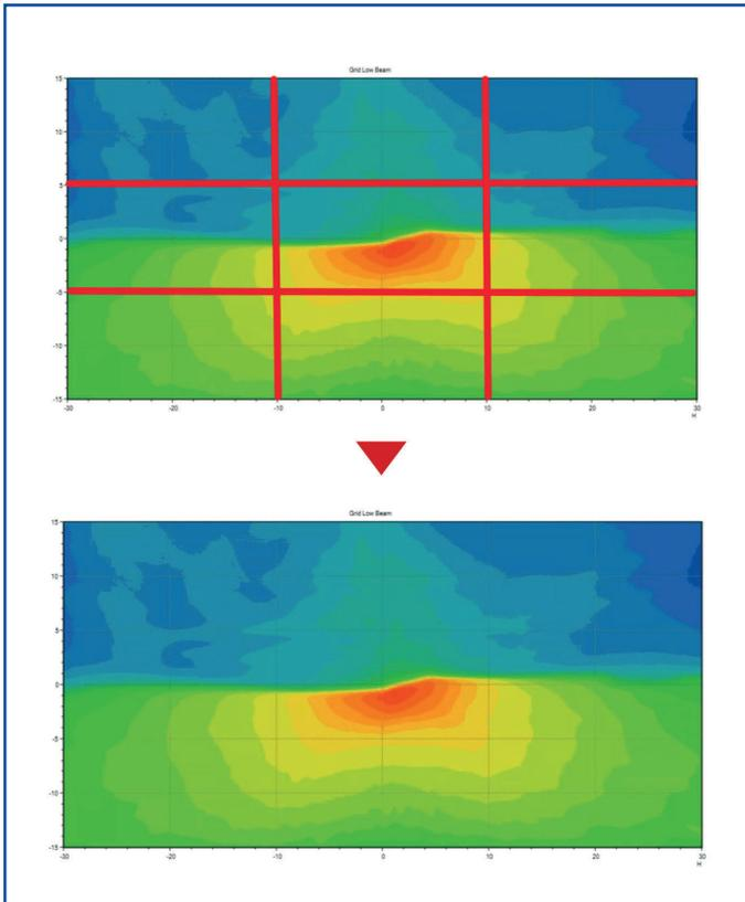
Die vollautomatische goniometrische Messung der Lichtverteilung mittels Image Stitching wird über die etablierte LightCon-Software gesteuert, während die LumiCam 2400B eine Serie von Bildern aufnimmt.
